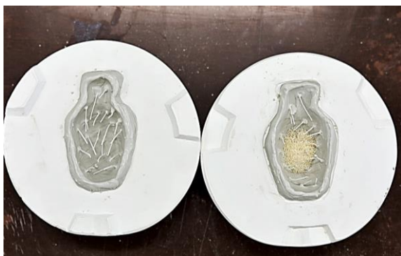
図10 徳利型鈴の内部構造
