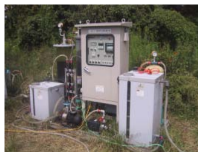
図1 リン酸イオン吸着装置(滋賀大学内)
