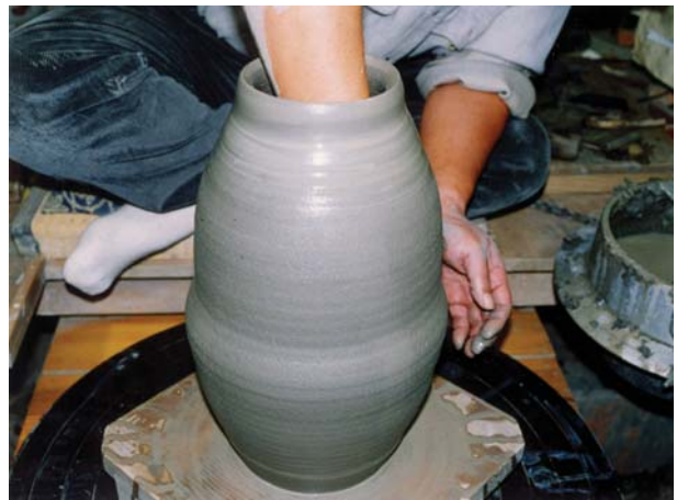
外側に手やコテを使わないで張らし作業を行なっている
