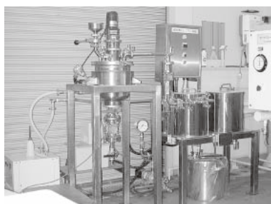
酵素触媒法による植物油燃料化のミニプラント
