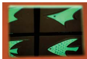
避難誘導標示板 Tile for Emergency Exit Sign using Fluorescence Glaze 蓄光蛍光釉薬使用 昭和57年(1982年) 滋賀県立信楽窯業試験場 滋賀タイル 日本国特許登録番号 1428043
