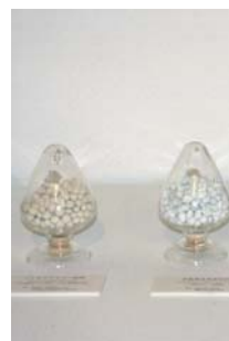
バイオリアクター担体 Porous Ceramic Bioreactor 中空樹脂粉末を利用した多孔質軽量陶器 平成7年(1995年) 滋賀県立信楽窯業試験場 日本国特許登録番号 3273310
