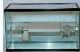
軽量発泡タイル Light Weight Tile アルミドロス・アプライト系多孔質軽量陶器 平成11年(1999年) 信楽窯業技術試験場 アルメタックス(株) 日本国特許出願中
