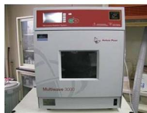
図1 マイクロウェーブ分解装置本体
