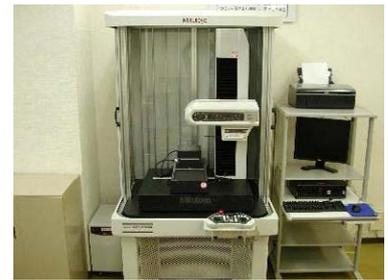
写真1 表面粗さ測定機
