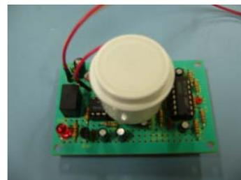
図3 焦電型赤外線センサ
