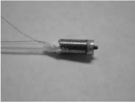
図2 押し付け型触覚センサ
