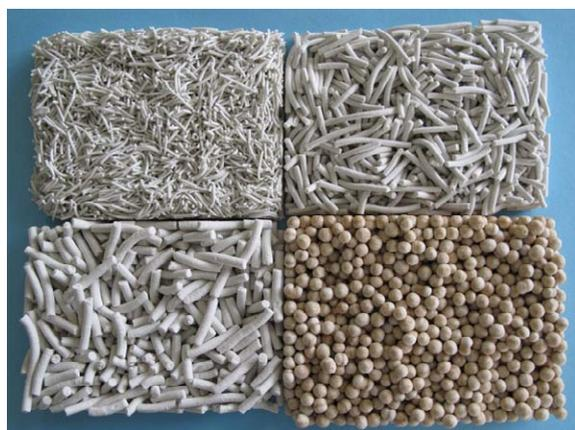
図3. 焼成試験体の外観（1200℃、薄）
