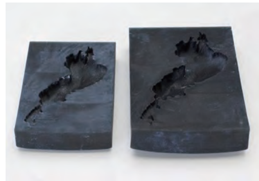
図2 3Dプリンターで制作した琵琶湖型
