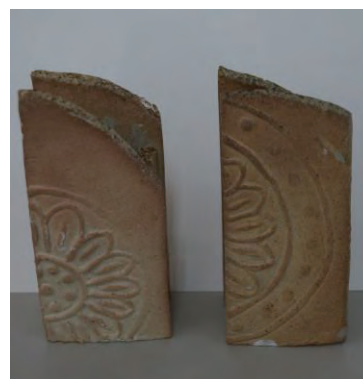
たたら成形による試作品 添加前(左) 14%添加(右)
