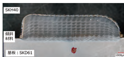
図 11 断面観察写真 (基板 SKD61 上に傾斜材料積層後、SKH40 材積層造形)
