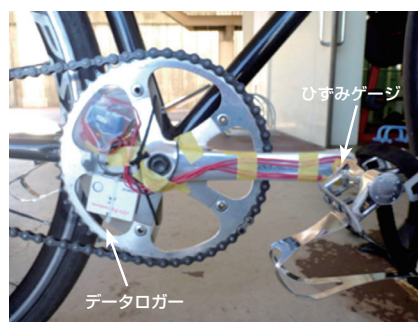
自転車に装着した小型ひずみ測定システムと測定結果
