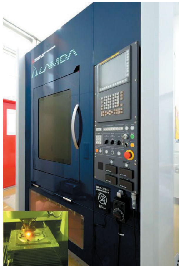
写真1 金属粉末積層造形装置 (DED方式) 三菱重工工作機械株式会社製 型式:LAMDA200
