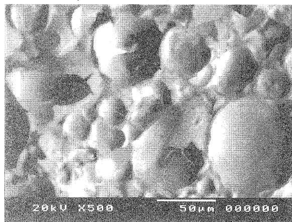
Fig. 3. M.Clay10%添加 1300℃焼成 破断面
