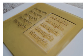
[感光性樹脂版] 露光：表面 300カウント 裏面 100カウント 洗い出し時間：120秒
