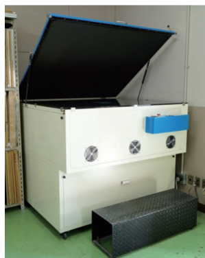
▲装置上面 ガラス天板の上にポジフィルム、スクリーン枠を置き、下から照射します。
