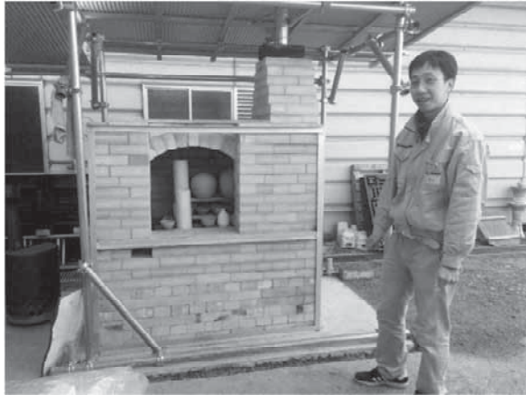
図 1 試験に用いたイッテコイ窯 炉壁の左に見える穴から塩基を乗せた溝形鋼を挿入
