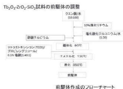
図1 Tb 2 O 3 -ZrO 2 -SiO 2 前駆体の合成フローチャート
