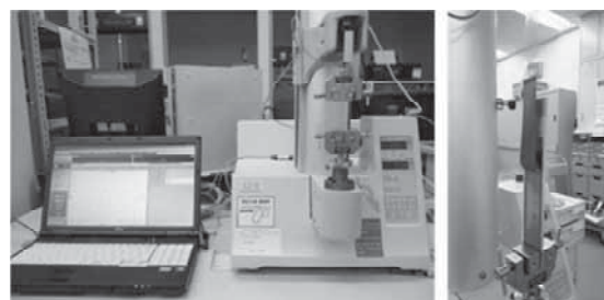
図2 低荷重物性試験機への取り付け
