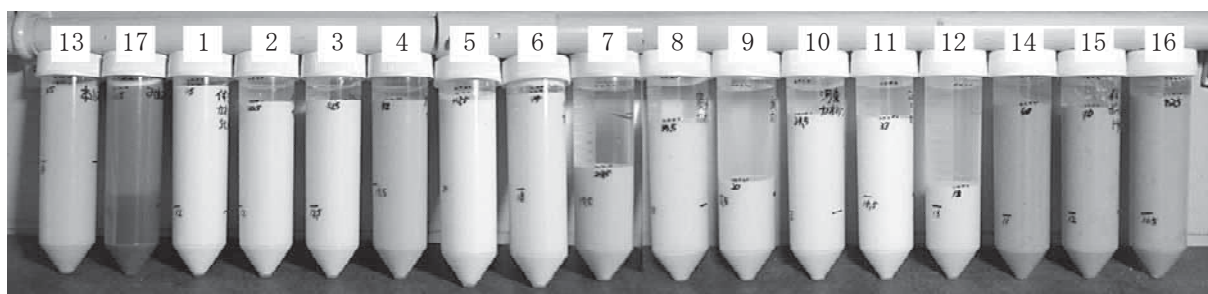
図 3 : 各種粘土の含水性能 (泥漿作製後、24 時間静置後)
