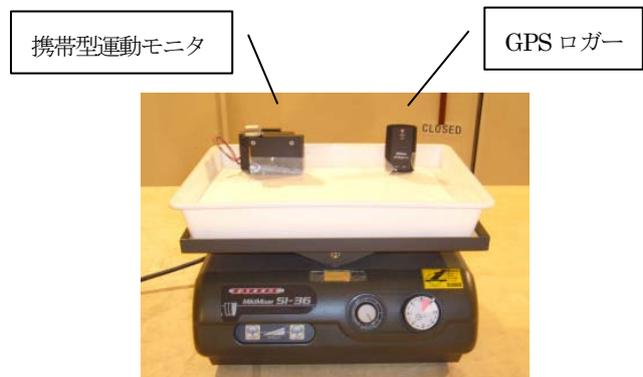
図7 振動台上に固定した供試品
