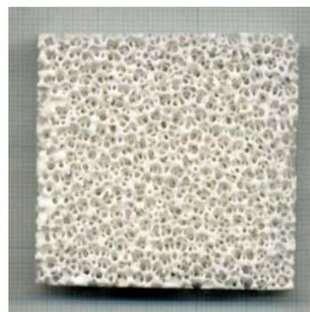
図1 基材セラミックフィルター
