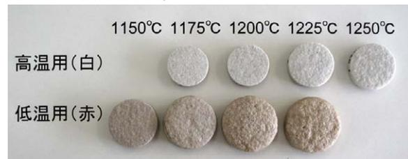
図 4. 焼成試験体の外観
