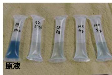
Fig.4 各種造粒体 0.3g を 60ppm リン酸イオン溶液 5cc に浸漬し 24 時間後のパケットテスト
