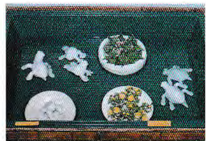
バブルセラミックス 発泡性素地による超軽量セラミック の試作品です。
