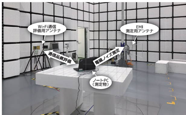
写真5 EMI測定 Wi-Fi通信品質評価同時実施中の様子
