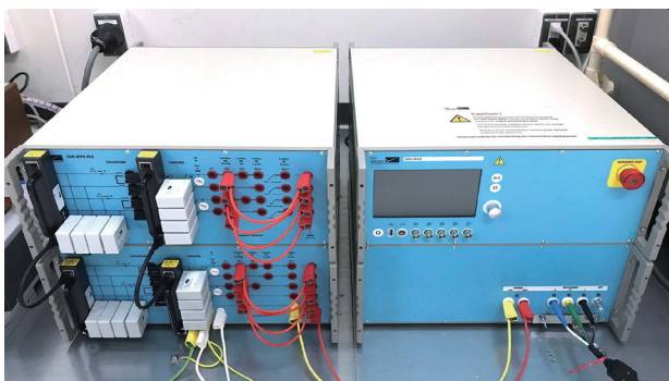
写真14 雷サージ試験システム
