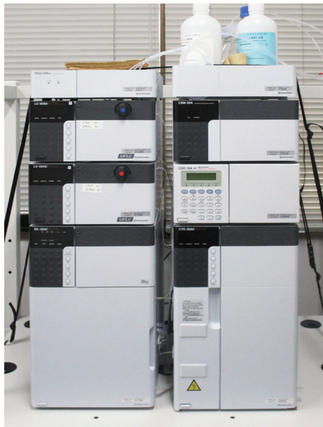
メーカー 株式会社島津製作所 型式 Prominence 有機酸分析システム
