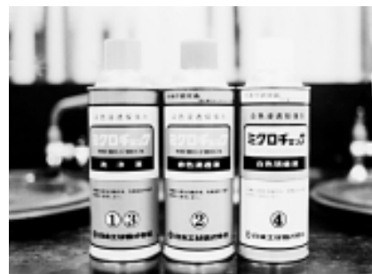
写真1 染色浸透探傷剤 洗浄液(左)、浸透液(中)、現像液(右) 日本工材株式会社
