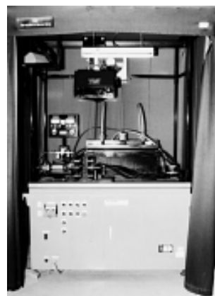
写真2 磁粉探傷装置 電機磁気工業株式会社 ER-26YD
