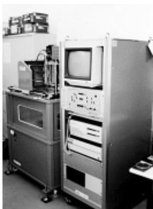
写真4 超音波探傷システム クラウトクレーマー株式会社 USIP-12T 川崎アドバンテック株式会社 KUSS-120TS
