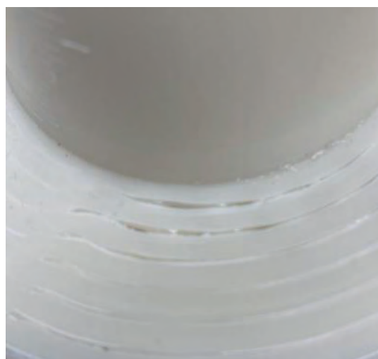
図 6 隙間ある造形体の切削加工後の表面
