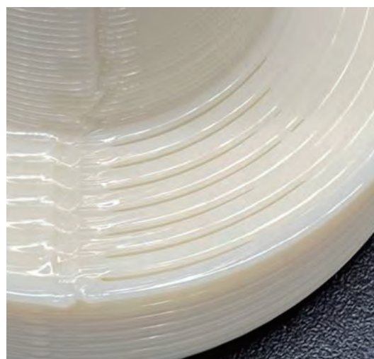
図3 射出幅不足による隙間
