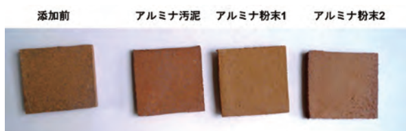
図6 赤土への無機系廃棄物添加による色の变化
