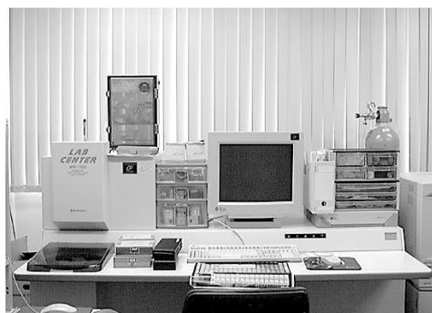
この装置は鉄鋼、非鉄、窯業や電子材料など様々な分野の材料の元素分析(定性、定量分析)がおこなえる。他の分析装置と違う点は、原子番号4のBeから92のUまでの元素について分析が可能であり、元素によって違いますが数10ppm ~ 100%までの測定が出来ます。また、今回導入しました装置は、1mmの局所分析および元素マッピングができるという特徴があります。
