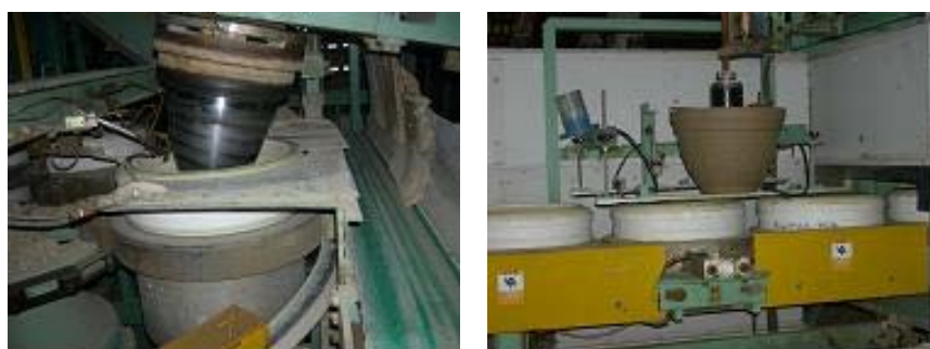
図 ローラーマシンによる植木鉢の成形と脱型
