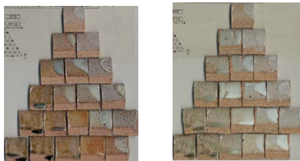
図 2. 釜戸長石 - 天然木灰 - 天然藁灰(左)、釜戸長石 - 合成木灰 - 合成藁灰(右)、(焼成：RFsk8、素地：ロット)
