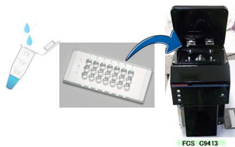
図2 小型FCS装置を用いた測定手順
