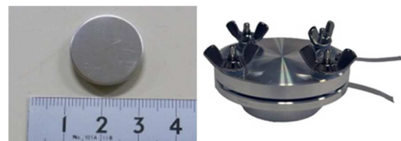
図2 測定セル (左:2032型コインセル、右:フラットセル)
