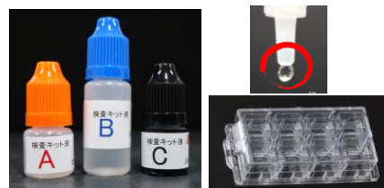
図6 精密ピペットなど実験器具がない場面でも、簡便な操作で測定試薬が定量分注、混合することが出来る「測定操作キット」の試作校正用の濃度ペプチド、希釈緩衝液、抗体溶液がそれぞれ、1滴の液量が一定量にばらつきが少なく滴下できるように先端形状は3Dプリンターを利用して作製した。
