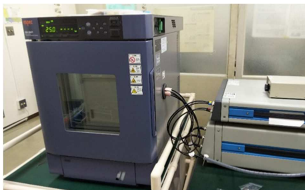
図 3 測定環境 (Solartron1287+1260および恒温槽)
