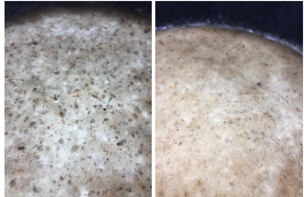
図10 掻き落としをした表面(左)、転圧のみの表面(右)
