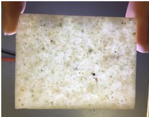
図9 たたら成形による試作品
