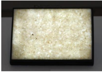
図12 テラゾー風透光性パネルの試作品
