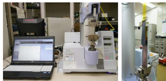
図2 低荷重物性試験機への取り付け
