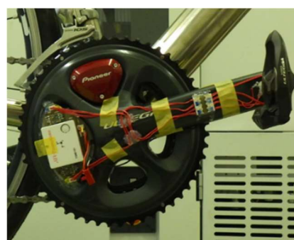
図1 再設計した小型ひずみ測定システム
