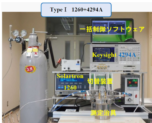
図5 1260と4294Aを使用したインピーダンス測定システム (Type I)
