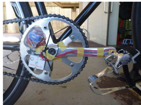
図 6 競技用自転車に装着したひずみ測定システム
