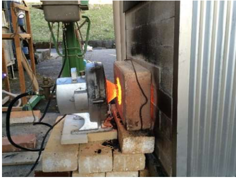
図4 ロータリー式灯油バーナによる昇温
