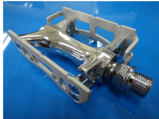
図11 踏み板の破損
