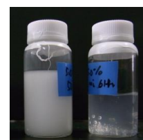
図3 熱処理後分散液 (左:50℃ 右:100℃)
