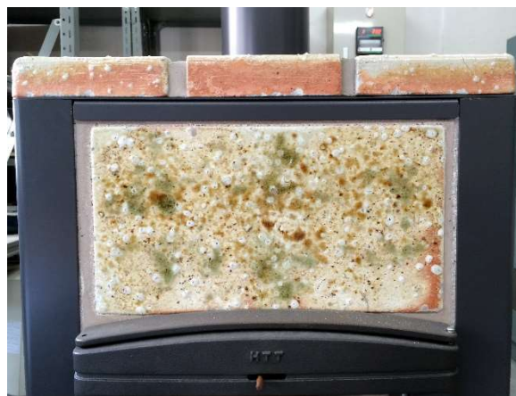
図3 陶器製薪ストーブ外装タイルの窯変
