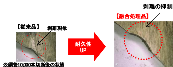
図2. 鋼管切断刃の試験後の状態
