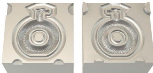
図3 3DCADで作成した押し型のモデルデータ
