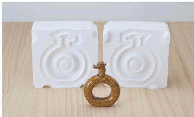
図4 押し型と完成したミニチュアの干支
