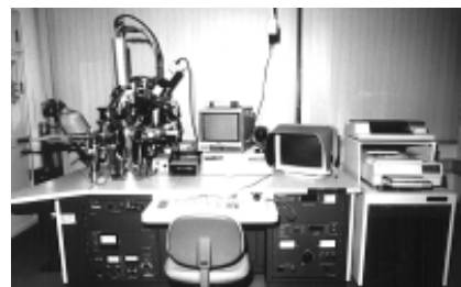
●X線光電子分光分析装置(XPS、ESCA) アルバック-ファイ ESCA Model 5400
