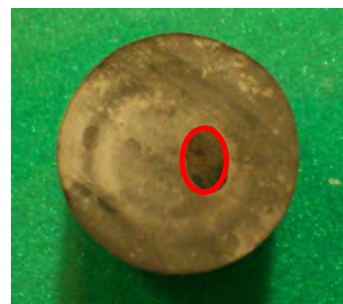
図 570°C 処理試料表面 図中○印は被膜未形成部
