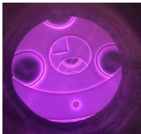
図2 窒化処理中のプラズマ状態
