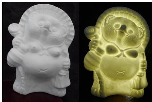
図8 生物由来合成ハイドロキシアパタイトの添加量60%の素地の鋳込み成形による試作品(1280°C焼成)
