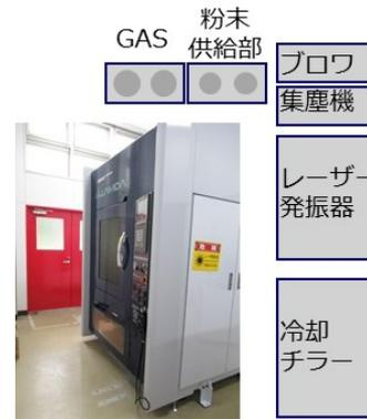
図2 金属3DプリンタLAMDA200の装置概略
