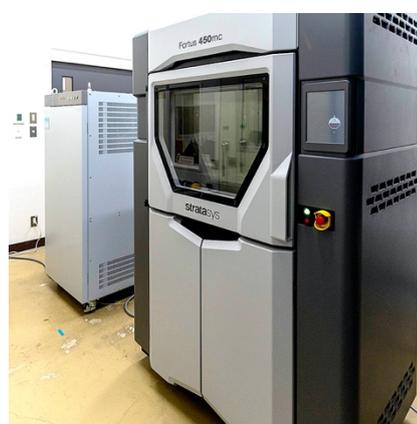
写真2 熱溶融式3Dプリンタ (平成29年度内閣府補正予算、平成30年度導入)
