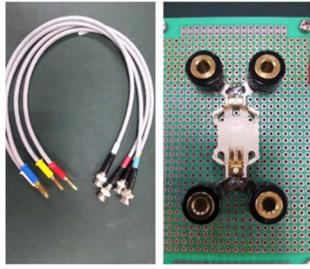
図3 試作した測定治具と接続ケーブル
