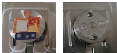
図3 試料表面の導電性を確保する方法
