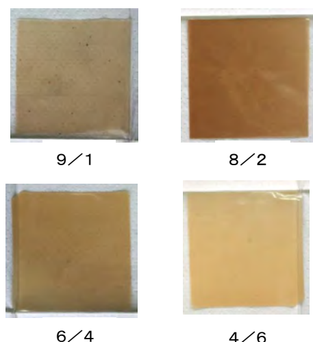
図2 緩衝液/アセトン混合溶媒中、モノマーを \alpha -クレゾールとして得られたポリマーを添加して得られたLDPEフィルム(数字は緩衝液/アセトンの混合溶媒比)
