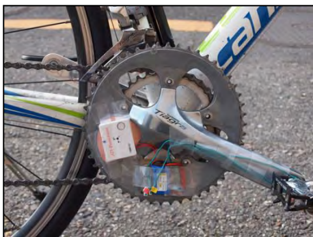
図3 ひずみ測定システムを装着したクランク
