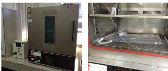
図3 洗浄試験に用いた全自動加湿洗浄装置と恒温槽(左)および洗浄中の恒温槽内の様子(右)
