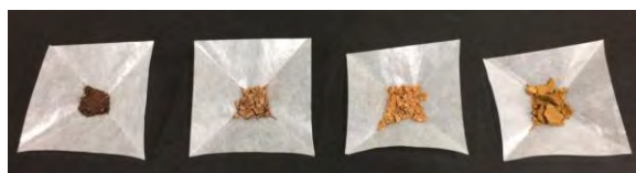
図1 緩衝液/アセトン混合溶媒中、モノマーを o -クレゾールとして得られたポリマーの外観写真(左から順に、9/1、8/2、6/4、4/6)
