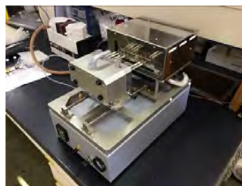
図1 Tenax吸着管の洗浄に用いたチューブコンディショナー(TCS-20)
