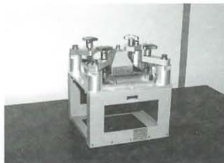
写真②-2 近接界用評価器
