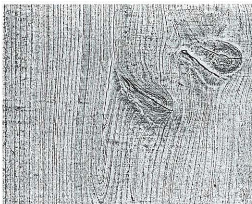
図2 木板の節とひび割れ (試料2)
