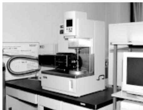
写真5 樹脂溶融粘度測定部
