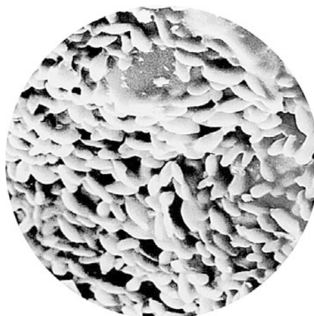
写真2 担体内部に固定された酵母
