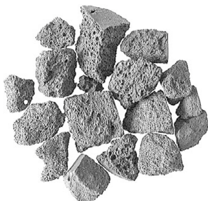
写真1 排水処理に用いる担体
