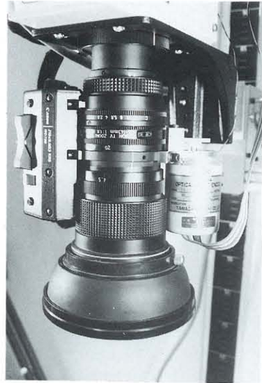
写真(1)ズーム機構の回転位置読み取り装置
