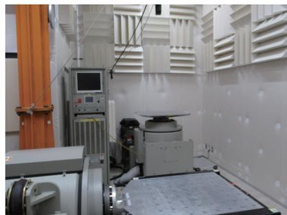
写真7 振動試験室内部への吸音材の取付け
