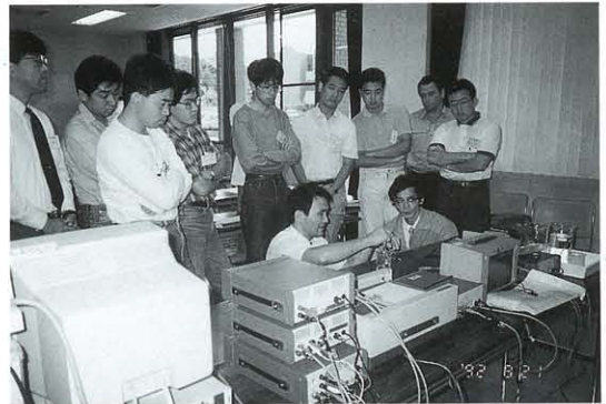
防食技術基礎講座、ポテンシヨススタッフによる腐食実験
