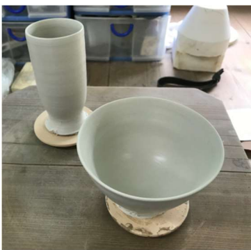
図3 手ろくろ成形により作成した試験体
