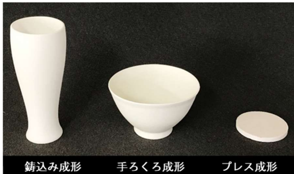
図6 各種成形方法による試作品(焼成温度:1280°C)
