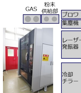
図2 金属3DプリンタLAMDA200の装置概略
