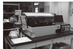
名称 ねじ緩み試験機 型式・メーカー JUNKER type ケイエスティ株式会社 (島津試験機サービス株式会社 製造) 準拠規格 DIN 65151
