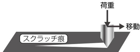
図2 スクラッチ試験概要図
