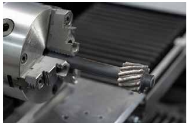
図7 ロータリーテーブルおよびCAMを用いた丸棒上へのヘリカルギア造形例
