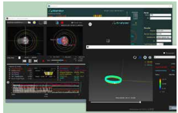
図9 金属3Dモニタリングシステムを用いた積層箇所の解析例
