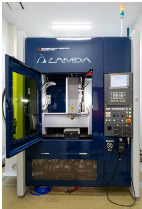
図1 粉末DED方式金属3Dプリンタ LAMDA200 日本電産マシンツール(株)(旧：三菱重工工作機械(株))製
