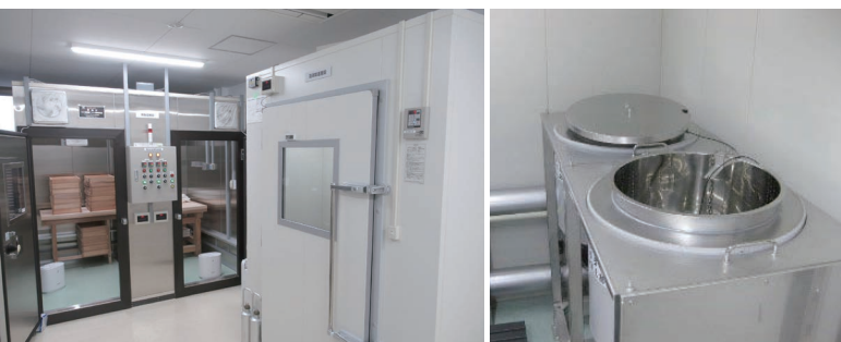
▲麹・酒母 製造施設 ▲発酵施設内のサーマルタンク ※酒母…本醸造前にアルコール生産酵母を純粋に大量に培養したもの
