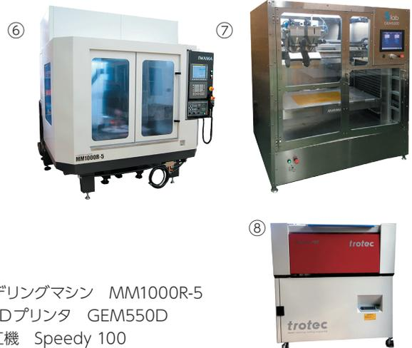
【写真⑥】大型5軸モデリングマシン MM1000R-5
