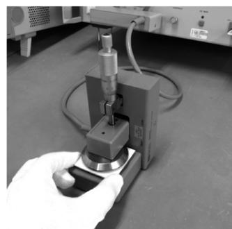
試料と電極（測定治具）
